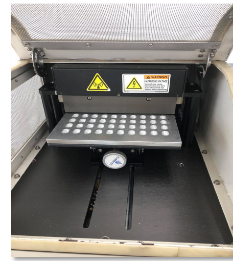
2.นำถาดหลุมใส่ในเครื่อง DBD
